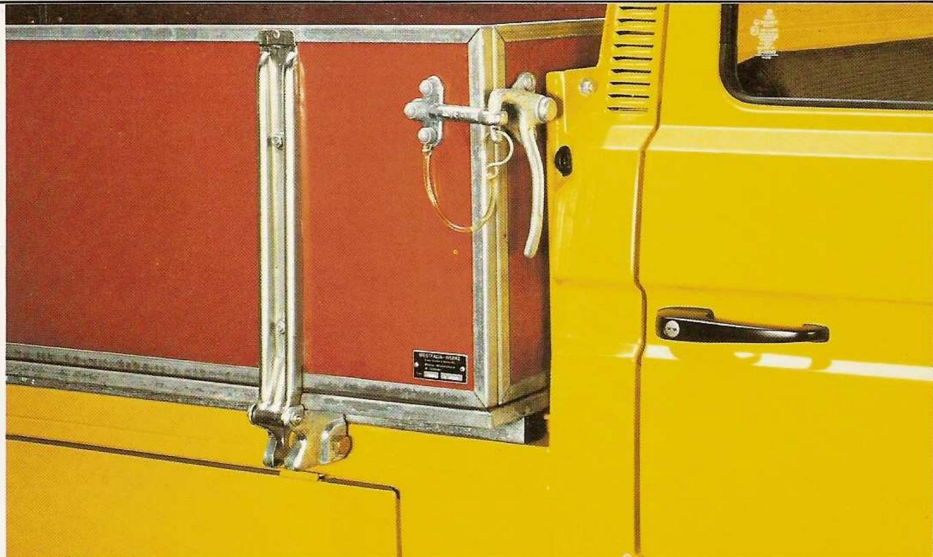
Les ridelles du Pick-up sont munies d'un verrouillage de sécurité. Un système simple et robuste qui se manœuvre facilement. Ainsi
