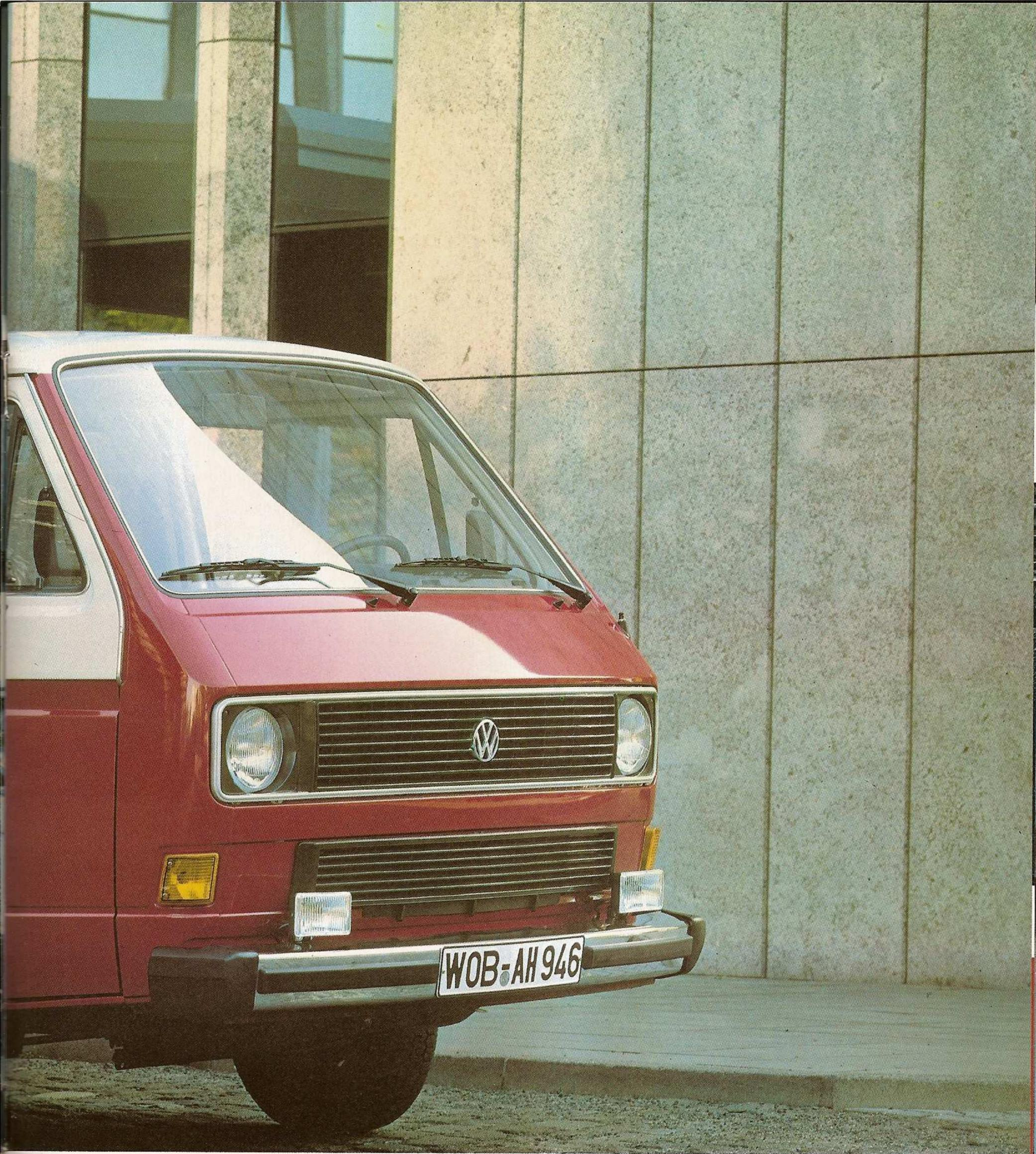
velle CL possède les solides qualités de base du Transporter. Par exemple le silence: son moteur étant disposé à l'arrière et son habitacle bien isolé, la Caravelle a un niveau sonore analogue à celui d'une voiture de tourisme. Ou encore l'efficacité de la suspension: avec son train de roulement bien équilibré (roues indépendantes, doubles triangles transversaux avec barre stabilisatrice à l'avant, bras longitudinaux obliques à l'arrière, déport négatif du plan des roues), la Caravelle
