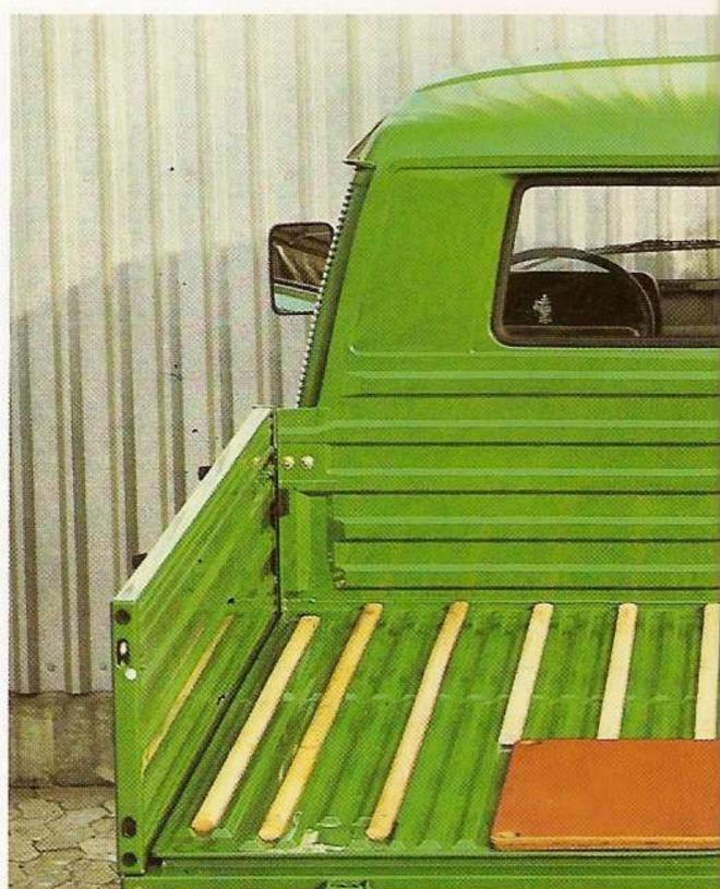
Le plateau de chargement du Double-cabine: 1,80 m de long, 1,74 m de large. Il peut lui aussi être équipé (en option avec supplément de
