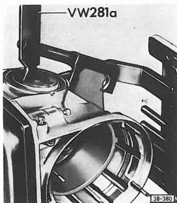
Fig. 11 Mise en place du piston de frein de 2e
