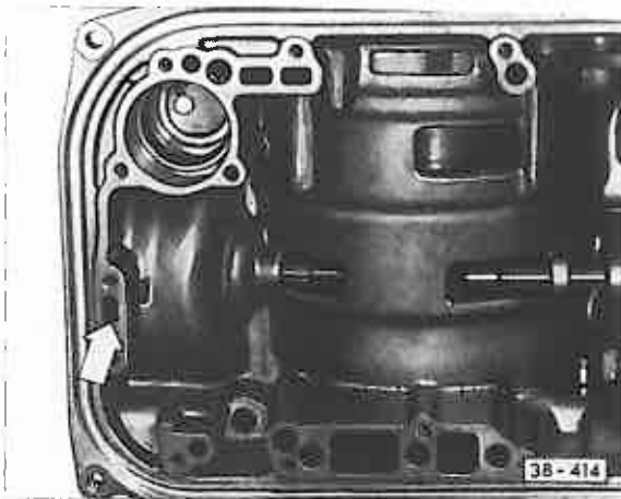
Fig. 13 Frein de 2e: contrôle du fonctionnement
