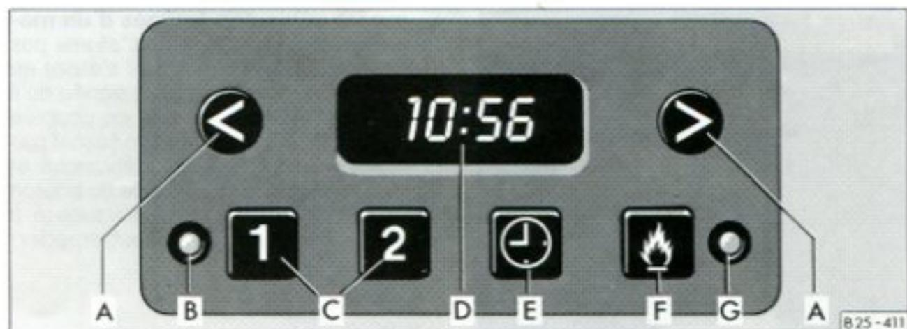
Le chauffage est alimenté en carburant à partir du réservoir du véhicule. Il peut consommer jusqu'à un demi-litre à l'heure. La puissance calorifique s'élève à environ 4,5 kW (4000 kcal/h).
