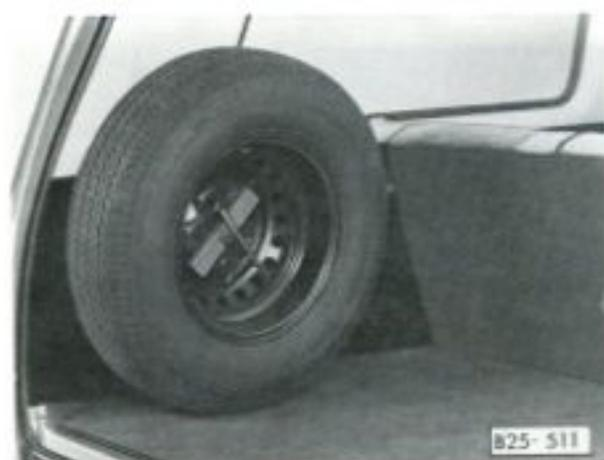
**La roue de secours se trouvant dans le coffre à bagages** est vissée au panneau latéral gauche. Pour la sortir, desserrez à la main la vis de fixation.
