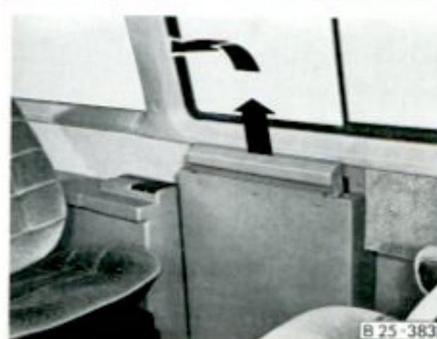
Sur les véhicules avec sièges individuels dans le compartiment-passagers, on trouve une table escamotable sur le côté gauche.
