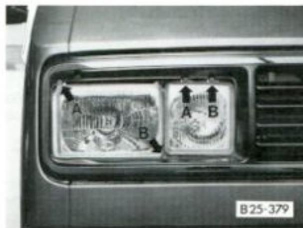
Les figures montrent la disposition des vis de réglage du phare droit. Les vis de réglage du phare gauche sont placées symétriquement.
