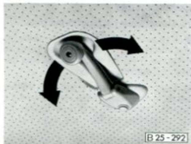
Le toit est ouvert et fermé à l'aide de la manivelle placée sur le ciel de pavillon au-dessus du siège du conducteur.
