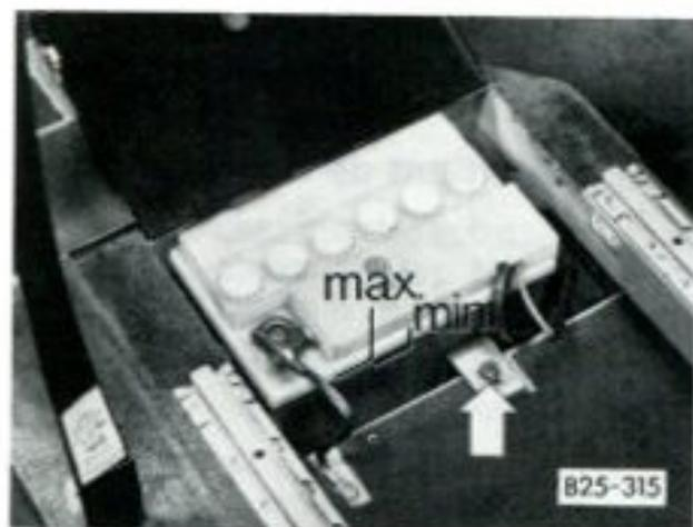
Sur les véhicules équipés d'un moteur à essence, la batterie se trouve sous le siège du passager avant. On y a accès en poussant le siège complètement vers l'avant.
