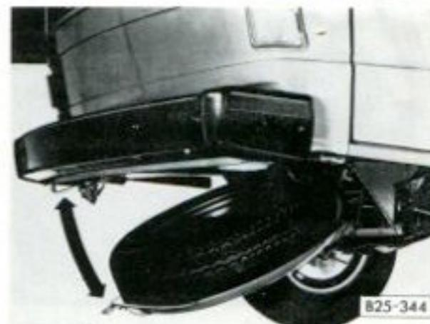
Pour la remise en place de la roue de secours – partie creuse vers le bas – poussez celle-ci sur le cuvelage. Rabattez avec élan le cuvelage vers le haut afin que le crochet d'arrêt s'encliquette. Puis revissez le boulon six pans et bloquez-le.
