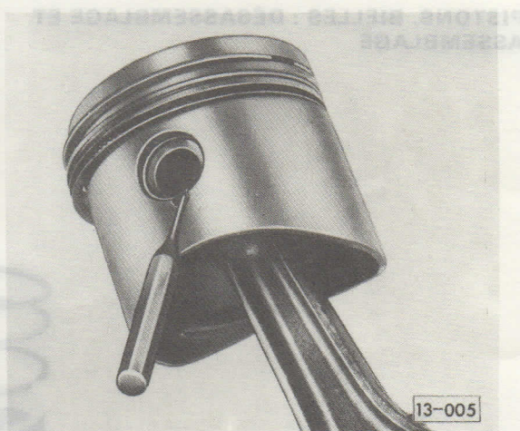
Fig. 4 Segment d'arrêt : extraction en faisant lever
