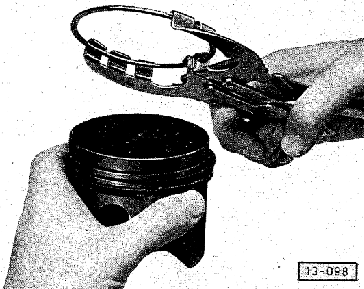
Fig. 1 Segments de pistons: d + r
