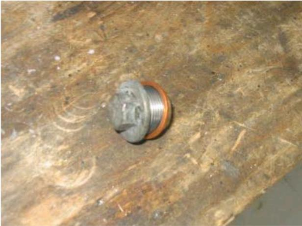
Je visse et serre solidement à la clé à douille, sans abus. En effet, le carter est en alu, c'est à dire plus mou que l'acier du bouchon. Ne surserrez pas cette vis sous peine d'endommager votre carter !!!!
