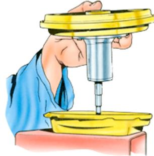
**2** Sortez verticalement l'ensemble du piston, contenant le diaphragme et la valve de commande. Déposez le diaphragme de l'intérieur de l'armature du piston.
