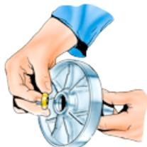
**2** Graissez généreusement le disque de réaction avant de le poser dans son siège son téton doit se trouver du côté intérieur du piston.
