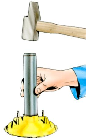
**2** Placez le couvercle sur une planche plate ; à l'aide d'un tube, d'un diamètre à peine inférieur à celui du joint (et de préférence en aluminium ou en bronze), chassez à petits coups de marteau le joint du couvercle vers l'intérieur de celui-ci.
