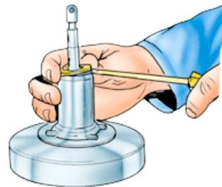
**4** En taisant levier avec un tournevis, décollez la bague de la queue du piston, en veillant à ne pas rayer la tige de la valve de commande.
