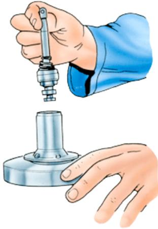
**1** Tirez l'ensemble de valve verticalement, en veillant à ne pas le faire frotter dans l'orifice de la queue du piston. Le filtre à air repose sur la valve, dont il est séparé par un petit ressort.
