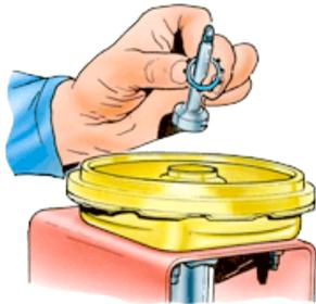
**1** Soulevez la tige de poussée de son siège dans le piston et déposez l'anneau d'arrêt avec le piston.
