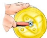
**4** Déposez l'anneau d'arrêt en le chassant depuis l'extérieur du cylindre à air à l'aide du manche d'un tournevis. Récupérez le joint d'étanchéité et sa rondelle, qui se trouvent collés sous l'anneau d'arrêt.
