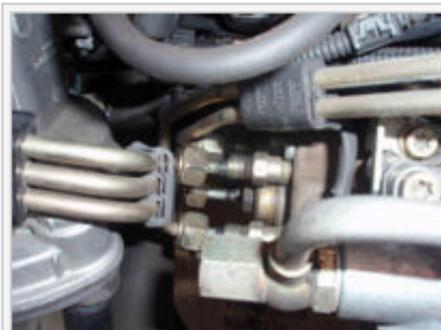
**1** - Dévisser les 5 raccords sur la pompe à injection, accessible par dessus et par dessous.
