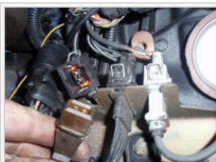
**5** - **A partir d'ici, c'est uniquement pour le TDI !** (Pour le 2,4D, le porte-injecteur se dévisse avec la douille de 27)
