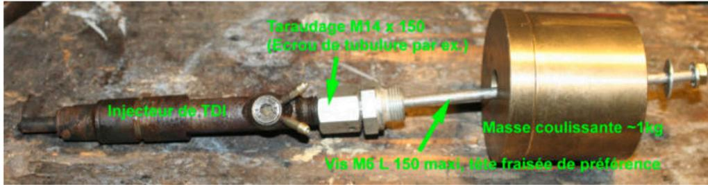
**9 bis** - Encore mieux et plus efficace : l'extracteur à inertie ! Un écrou de tubulure, une vis M6 longue (tirant d'alternateur), un écrou et une bonne masse, rien ne résiste ! Frapper doucement suffit en général, sinon faire de plus en plus fort.
