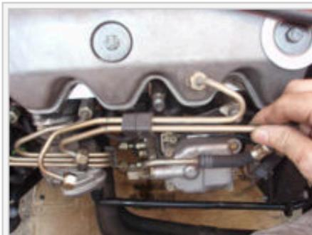
**3** - Retirer les tubulures, sans les déformer.
