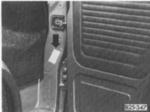
Das Typschild befindet sich vorn am rechten Türholm zwischen den Türscharnieren.
