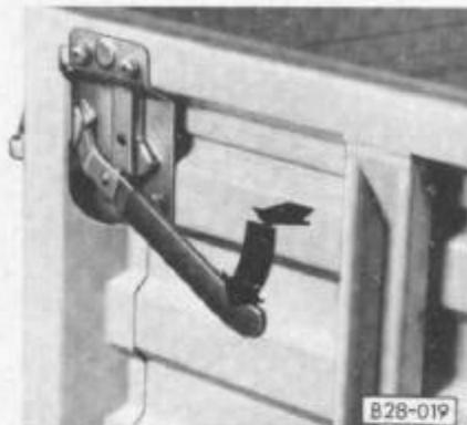
Zum Abklappen der Bordwände Griff des Verschlusses so weit von der Bordwand abziehen, bis der Sicherungsstift aus dem Arretierungsloch gehoben ist, dann Griff nach unten schwenken.
