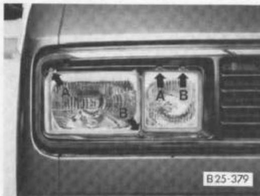
Die Abbildungen zeigen die Anordnung der Einstellschrauben des rechten Scheinwerfers. Die Einstellschrauben des linken Scheinwerfers sind spiegelbildlich angeordnet.
