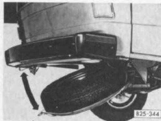
Das Reserverad befindet sich entweder vorn unter dem Fahrzeugboden auf einer nach unten klappbaren Schüssel oder hinten im Gepäckraum.
