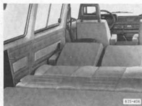
Der Raum unter der Sitzbank kann als Stauraum benutzt werden. Dazu ist es erforderlich, die Sitzbank vorne etwas anzuheben. Sie bleibt in angehobener Stellung, wenn die Stütze, die sich links an der Schiebetürseite befindet, hochgeklappt wird.
