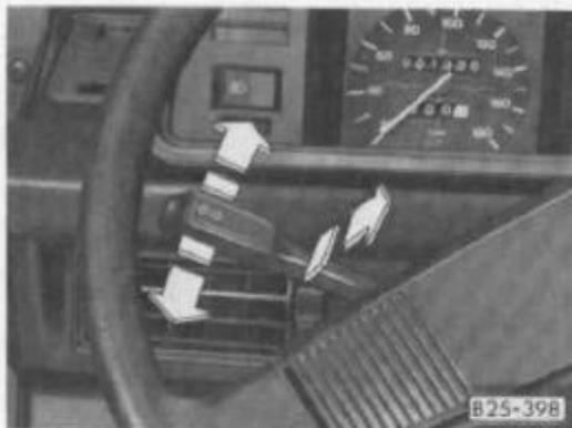
Die Blinkanlage arbeitet bei eingeschalteter Zündung.
