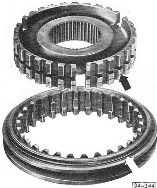
Fig. 6 Baladeur et synchroniseur de 3ème et 4ème: assemblage
