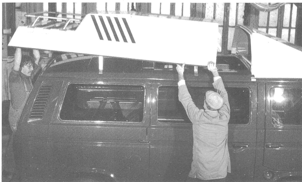
Zuletzt wird die hintere Dachschalenhälfte auf den Wagen gehievt und mit den Haltern und der vorderen Schale verschraubt.
