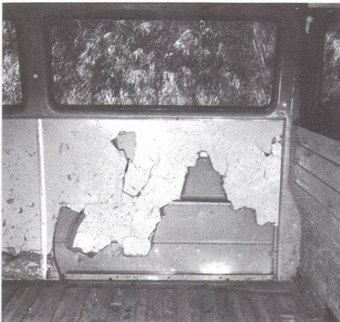
Gebrauchtwagen aus Firmenbesitz präsentieren sich bisweilen in stark verfallenen Zustand. Die hier sichtbare zerfetzte Seitenverkleidung ist nur „die Spitze des Eisbergs“.
