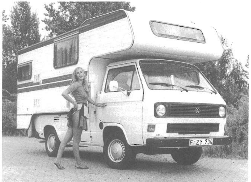
Das Tischer-„Huckepack“-System: Die Wohnkabine wird einfach auf das unveränderte Basisfahrzeug gestellt.
