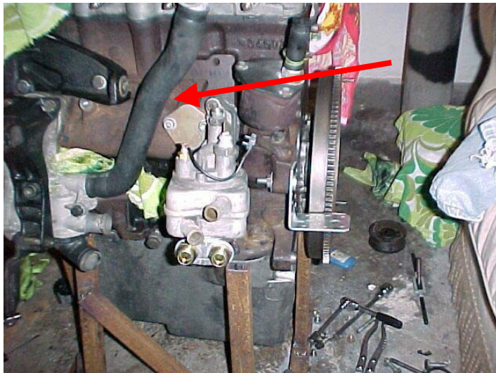
Montierter Kühlwasserschlauch für den kleinen Kühlwasserkreislauf
