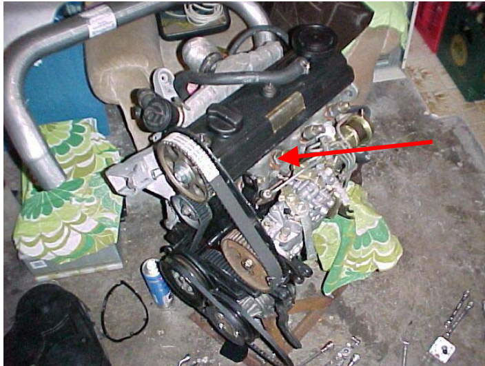
Die Einspritzdüsen mit Kupferpastenring
