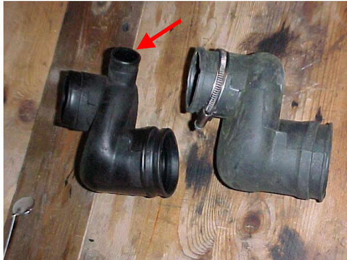
Das Bild zeigt links die alte Version des Verbindungsstückes und rechts die neue Ausführung. Der Pfeil zeigt den Unterschied.
