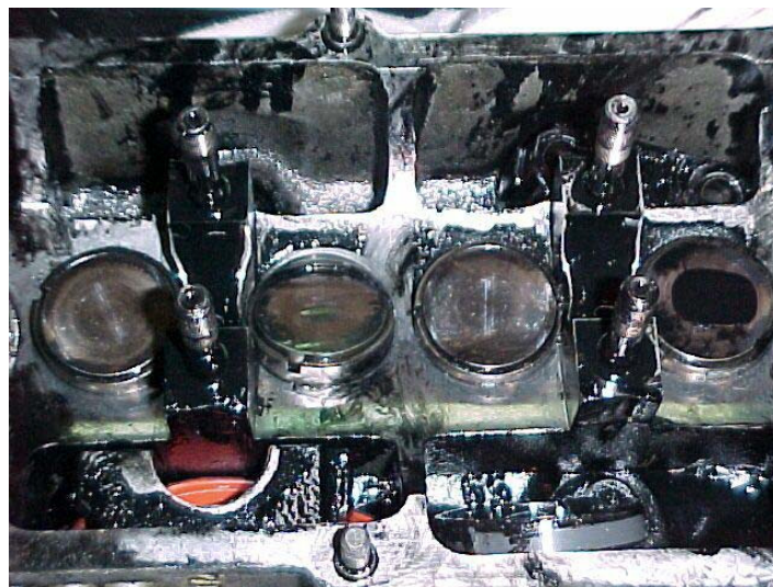
Der Zylinderkopf des Spendermotors, man erkennt deutlich am linken Tassenstößel den Schaden (Tassenstößel im Kopf verkantet, aufgrund Schlag des Kolbens auf das Ventil)
