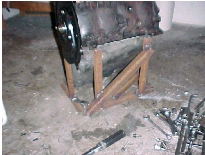
Das Montagegestell, deutlich zu erkennen, das es sich am Rand der Ölwanne abstützt
