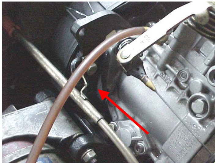
Befestigung des Peilstabes am kleinen Zwischenhalter zwischen ESP-Halter und Lima-Halter
