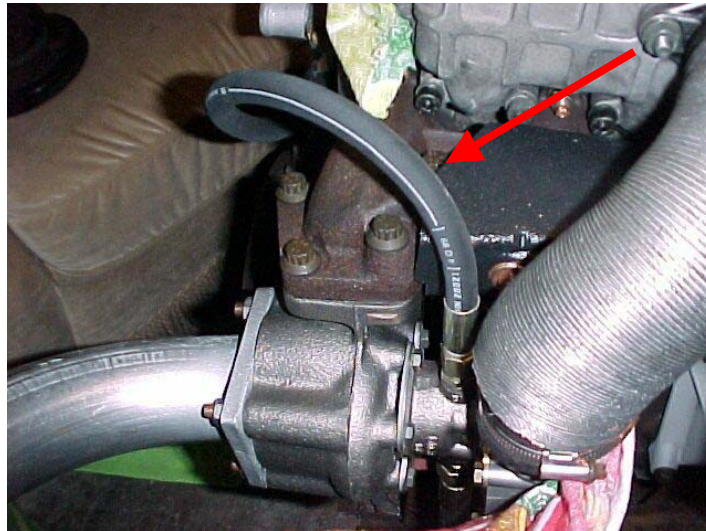
... und am Turbolader (Pfeil). Die Rücklaufleitung ist auf dem nächsten Bild zu sehen (Pfeil rechts).
