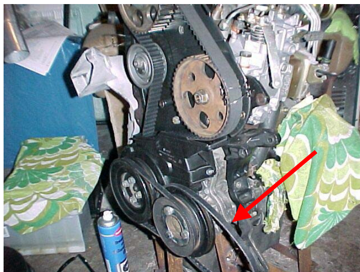
Riemenscheiben auf Kurbelwelle und Wasserpumpe, der Pfeil zeigt den Keilriemen für die Lichtmaschine
