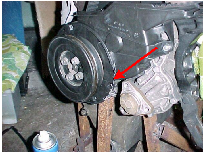
Nach der Montage des unteren Zahnriemenschutzes werden die Riemenscheiben auf der Kurbelwelle montiert. Der Pfeil zeigt die Ecke, die entfernt werden muss.
