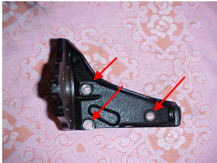
Der ESP-Halter mit den aufgefrästen Löchern (Pfeile).
