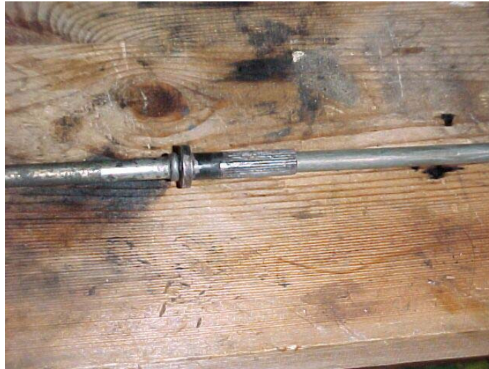
Der Oelpeilstab mit aufgeschobener Hülse vom alten AAZ-Peilstab
