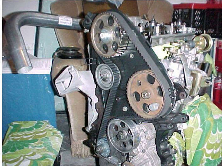
Kompletter Zahnriementrieb ohne Verkleidungen
