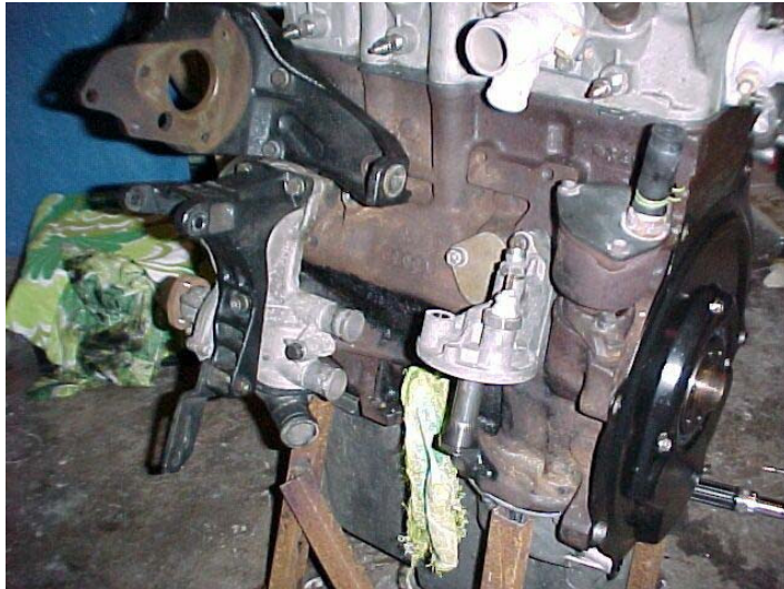
Montierte Wasserpumpe mit Halter für die Lichtmaschine
