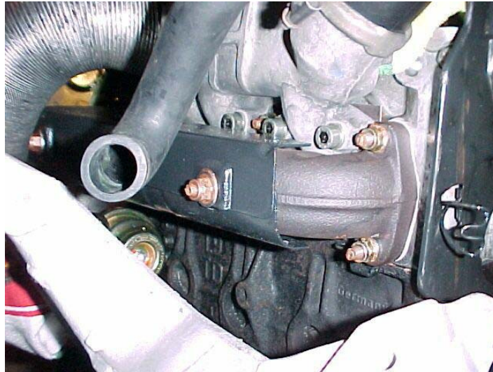
Der montierte Krümmer mit den Wärmeschutzblechen (Pfeil), darüber in hellerem Aluminium mit den Inbusschrauben das Saugrohr
