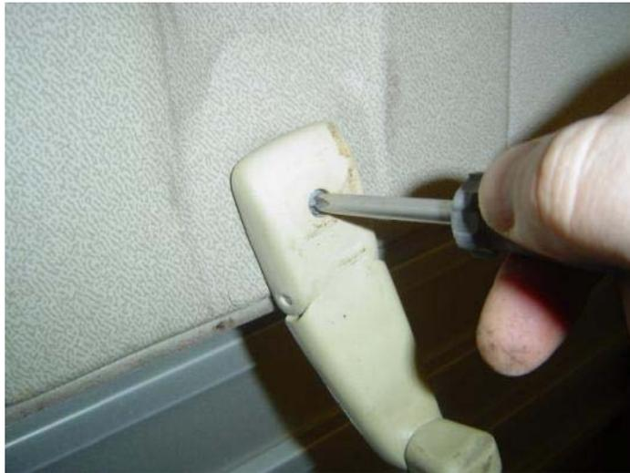
Déposez le cache en tirant dessus, du côté arrière
