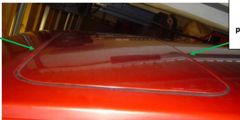
A l'arrière, le couvercle doit être plus haut d'1mm max que le toit
