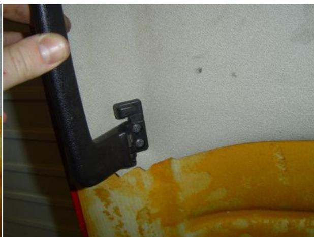
Le ciel de toit est maintenu sur sa partie centrale par 4 clips au lieu de 2 sur un toit normal
