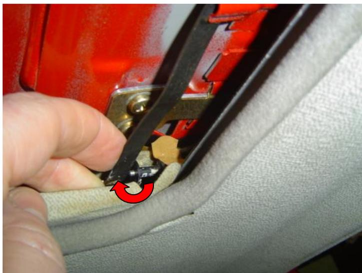
Pivotez la lamelle pour la déposer
