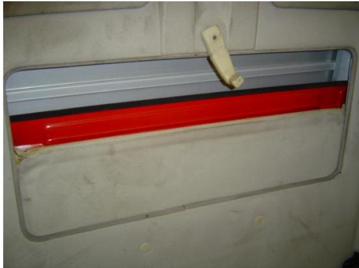
**En tirant dessus, déclipser la garniture intérieure (clipsée par 5 clips)**
