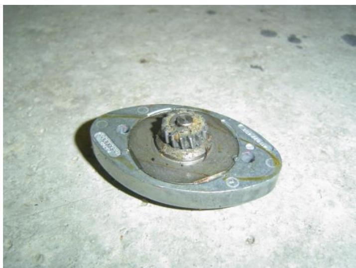
Déposez le mécanisme complet en tirant dessus vers l'avant
