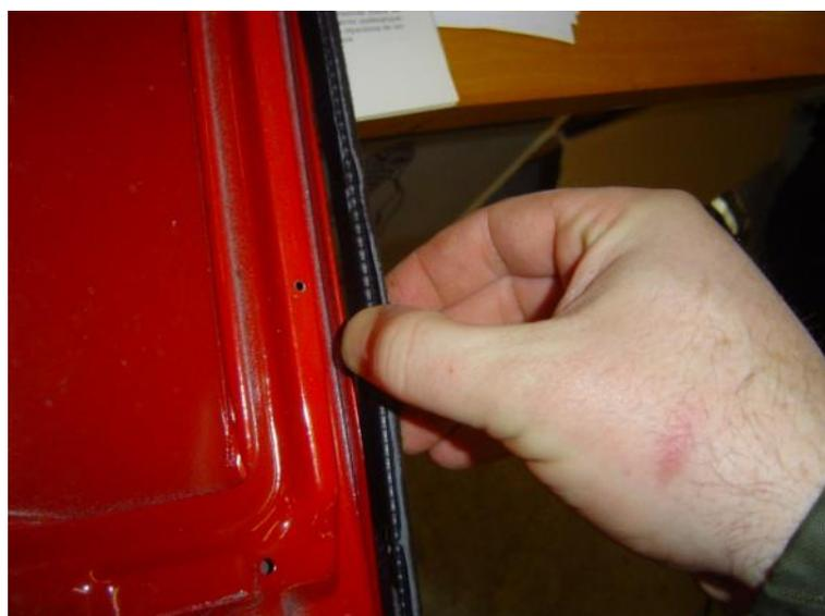
Le rhabillage se fait sans difficultés dans l'ordre inverse du déshabillage. Pour la pâte d'étanchéité, vous pourrez utiliser la pâte utilisée pour l'étanchéité des ailes (voir la rubrique 'les ailes avants')
