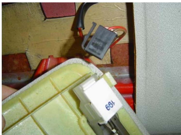
Déposez le petit boîtier de commande en déposant les deux vis
