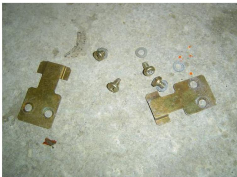
Déposez les 2 vis de fixation de la platine avant, idem de l'autre coté
