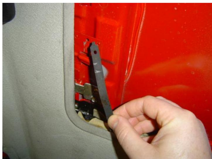
Déposez les 2 vis de fixation de la platine arrière, et déposez la platine
