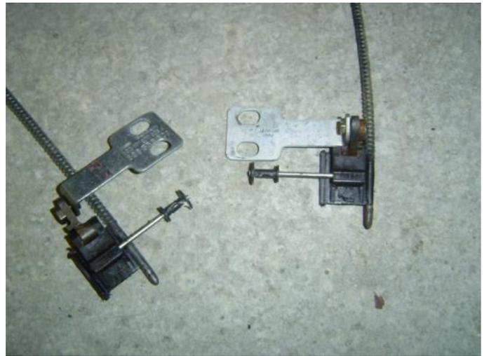
**Décrochez les rails, et déposez les platines centrales**
