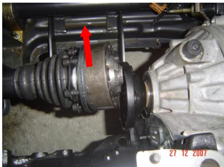
Chassez le joint homocinétique du moyeu de roue. Utilisez pour cela un chasse en métal tendre et un maillet si nécessaire, et déposez le cardan.
