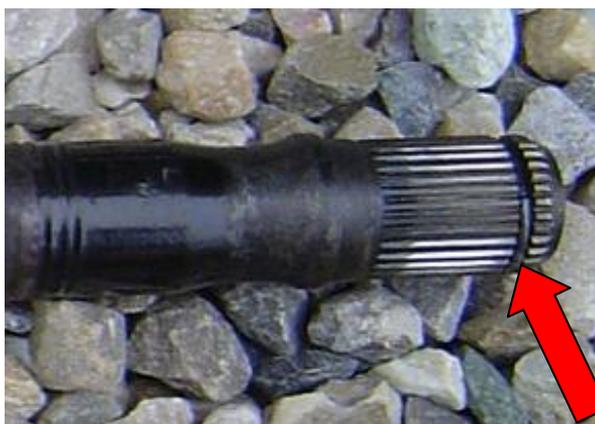
Insérez le joint sur l'arbre jusqu'en butée. Si nécessaire aidez-vous d'un maillet.
