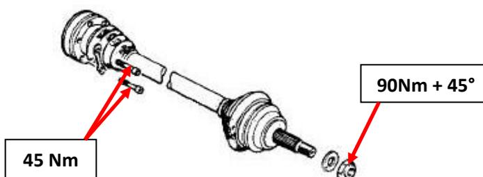
**Dépose du joint homocinétique coté roue :**
