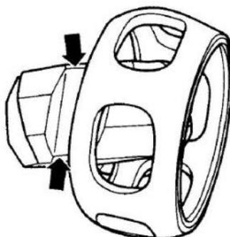
**Remarque** : les 6 billes font partie d'un groupe de tolérance, il ne faut donc pas les mélanger avec les billes des autres joints. Vérifiez qu'aucune partie du joint homocinétique ne présente de crevasses, ou de traces de grippage. Un jeu radial excessif se traduit par un battement résultant des alternances de charge. En pareil cas, le joint doit être remplacé. Des traces de polissage ou de roulement sur les billes ne justifient pas le remplacement du joint.
