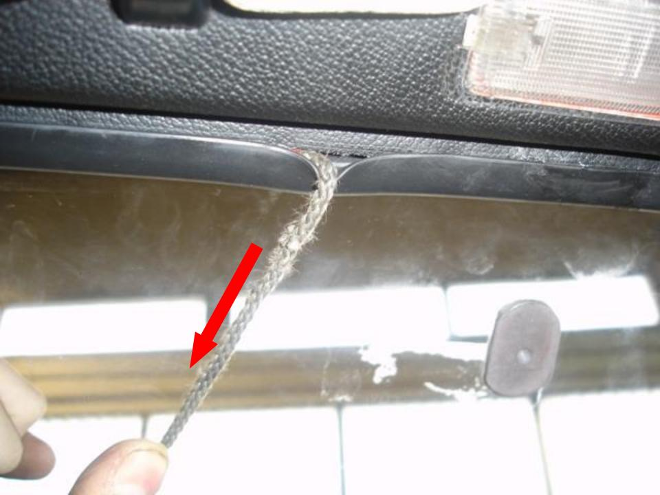
Pour finir, tapotez du poing le contour du pare-brise pour que le joint se met en place.
