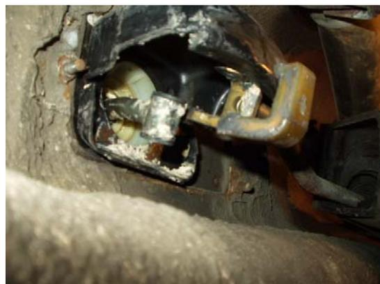
retirer la housse, dévisser la console centrale et le palier (3 vis)
