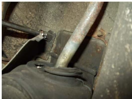
Démonter le boulon de fixation de la tringlerie au levier
