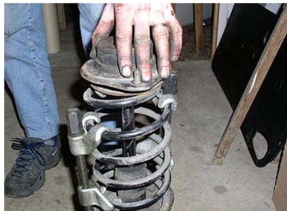
un fois le ressort tendu, dévisser l'écrou de la tige de l'amortisseur, retirer le palier puis le ressort
