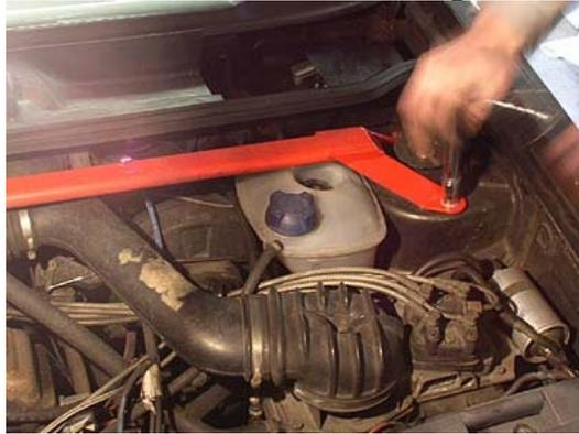
Tracer un repère de position sur la vis excentrique (c'est la vis supérieure) et la jambe pour ne pas « tuer » la réglage du train avant – un réglage pro est conseillé après démontage d'une jambe de force)
