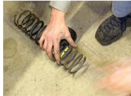
Placer el nouveau ressort en positionnant correctement la spire en appui sur l'amortisseur
