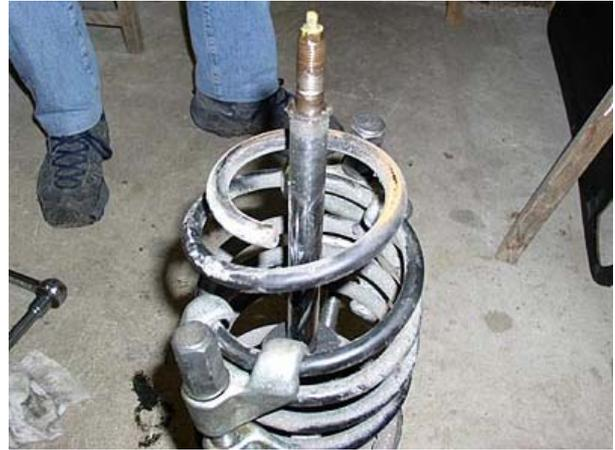
comparaison d'un ressort avant origine VW et d'un ressort Eibach,
