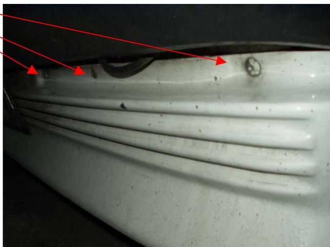
**Passages roues** : 4 rivets équidistants sur le rayon du passage de roue, tete plate grand diamètre
