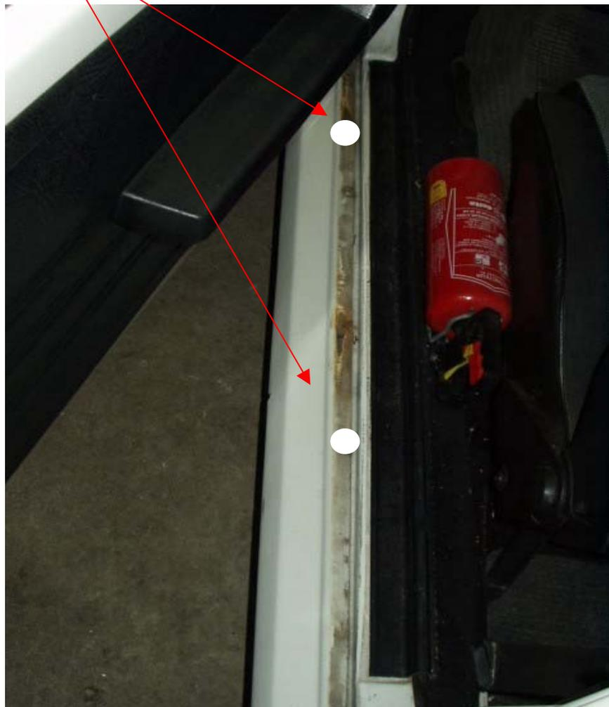
**Côté à l'extérieur** : 2 ou 3 rivets équidistants sur la longueur, tete plate petit diamètre
