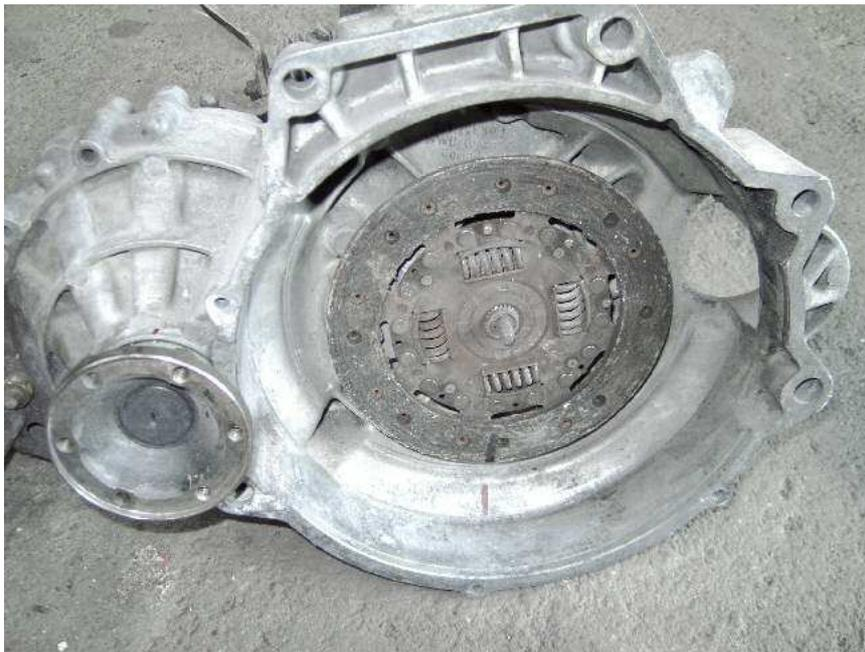
On effectue un tour d'un arbre de sortie et on compte le nombre de tours du disque d'embrayage. (Faites des repères pour plus de précision).
